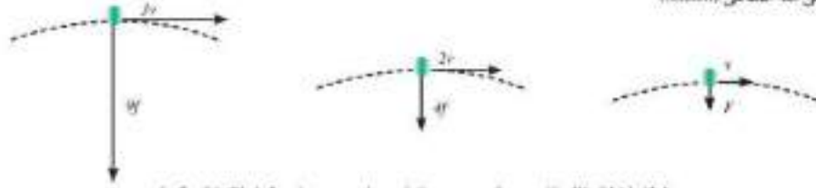
شكل (١٥) : تأثير تغير سرعة جسم يتحرك في مسار منحني على مقدار القوة المركزية
